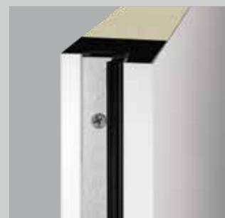
La puerta de uso general MZ Thermo46 se caracteriza por una hoja de 46 mm de grosor y un valor de aislamiento térmico de hasta  $1,1 \text{ W}/(\text{m}^2\cdot\text{K})$ .
